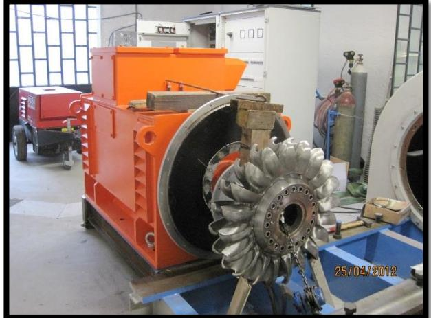
*Fig: installazione nuova turbina*
