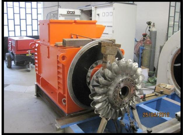
*Fig: installazione nuova turbina*
